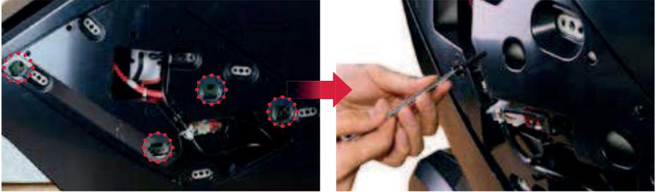
3.3| Um die Seitenabdeckung wieder zu befestigen, klopfen fest mit der Hand an die Kanten des Seitenteils.
